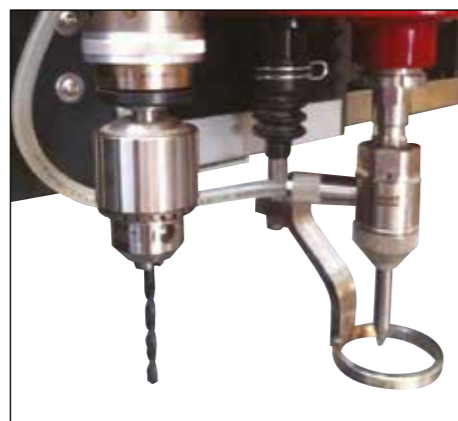
Pre-drilling and Counter Sink CNC mechanical system Sistema di preforo meccanico e bisellatura fori
